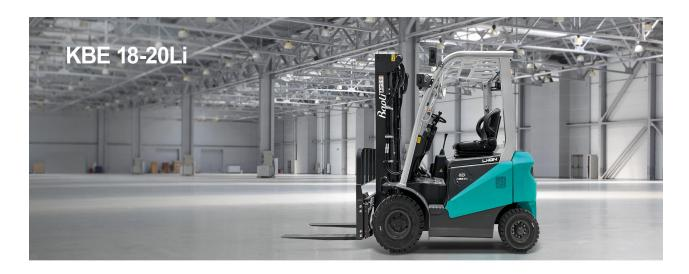
Die KBE 18Li und KBE 20Li mit einer Tragfähigkeit von 1,8 bis 2,0 Tonnen und einer maximalen Hubhöhe von 6,5 Metern sind dank ihrer Emissionsfreiheit und ihres geringen Geräuschpegels ideal für Logistik und Industrie, insbesondere in Innenräumen. Diese Stapler eignen sich besonders für leichte bis mittelschwere Einsätze und zeichnen sich durch ein kompaktes Design für eine einfache Handhabung auf engstem Raum aus.
