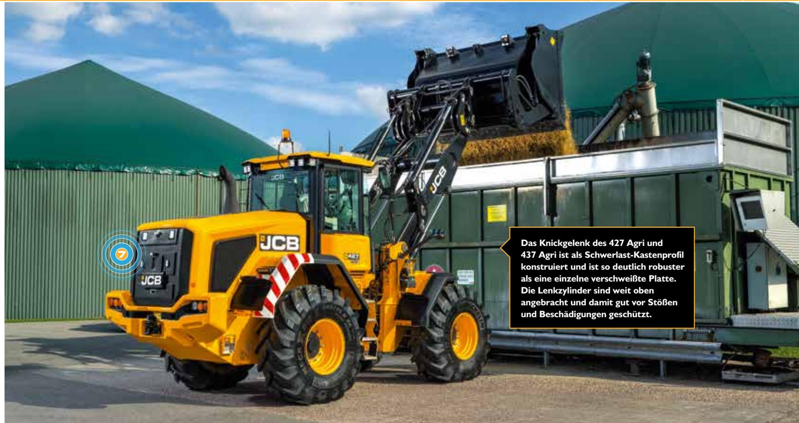
Das Knickgelenk des 427 Agri und 437 Agri ist als Schwerlast-Kastenprofil konstruiert und ist so deutlich robuster als eine einzelne verschweißte Platte. Die Lenkzylinder sind weit oben angebracht und damit gut vor Stößen und Beschädigungen geschützt.
