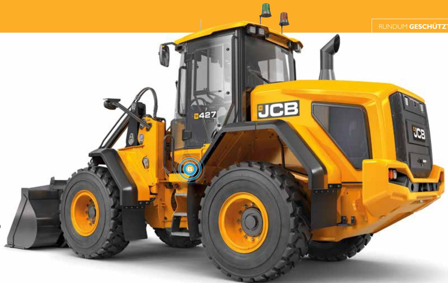
**6** Die neuen Schmutzabweiser an den vorderen Kotflügeln wurden optimiert, sodass hier nur wenig Spritzwasser entsteht. Dies erhöht die Sicherheit und verhindert übermäßige Schmutzablagerungen auf Ihrem Radlader.
